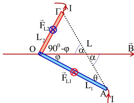
**Μέγιστη** τιμή του μέτρου της Laplace έχουμε όταν  $\eta \mu \alpha = 1$  ή  $\alpha = 90^\circ$ , όταν  $ΑΓ \perp \vec{B}$  με  $F_{L,max} = BI \sqrt{L_1^2 + L_2^2}$
