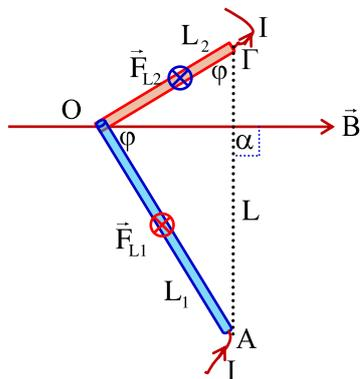
Εδώ έχουμε τη μέγιστη δύναμη Laplace  $F_{L,max} = BI \sqrt{L_1^2 + L_2^2} \dots$
